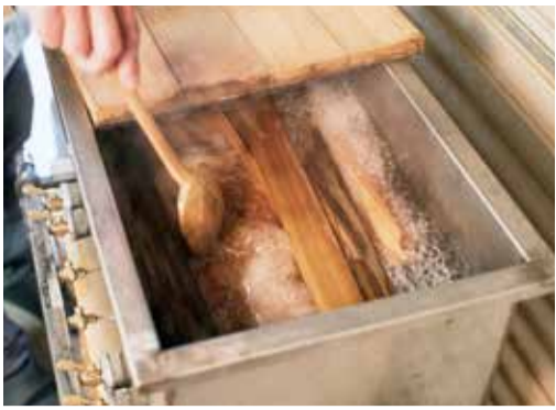
杉の角材を製材し、カンナで厚さ約3mmに仕上げた後、熱湯で1時間ほど茹でる。手間ひまのかかる工程が多く、完成までに10日程度かかる
